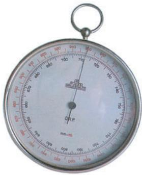
Barómetro, instrumento utilizado para medir la presión atmosférica.
